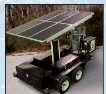
Groupe eau potable mobile autonome
